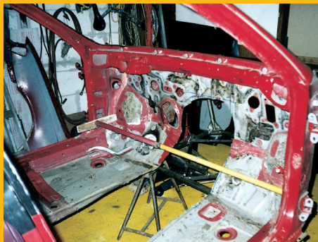
A karambolos karosszéria méreteinek helyreállítása után vágják csak ki a kardántengelynek és a kipufogónak szánt helyet a padlólemezről és a tűzfalról. A következő lépés a kardánalagút elkészítése volt
