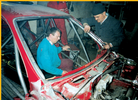
A karambolos karosszéria méreteinek helyreállítása után vágják csak ki a kardántengelynek és a kipufogónak szánt helyet a padlólemezről és a tűzfalról. A következő lépés a kardánalagút elkészítése volt
